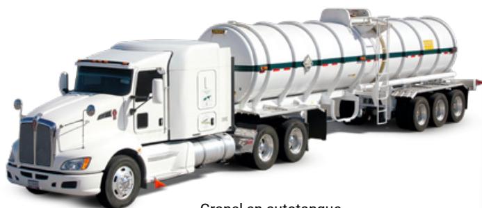
Granel en autotank de acero al carbón
